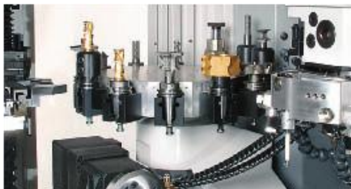
Com Magazine para ferramentas de corte para madeira
