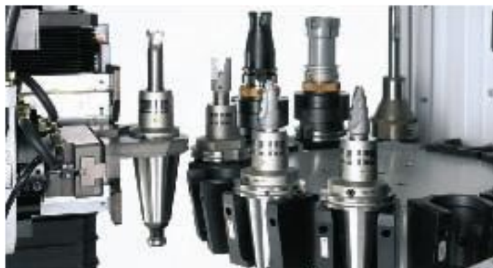
Troca rápida de ferramenta SK 50
