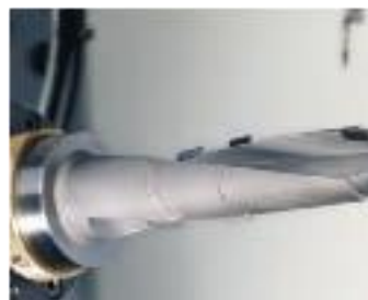
Ferramenta com hélice de várias etapas
