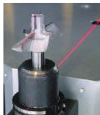
Alinhamento da ferramenta no Magazine
