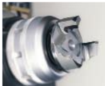
Ferramenta com cortantes internos (tipo campânula)
