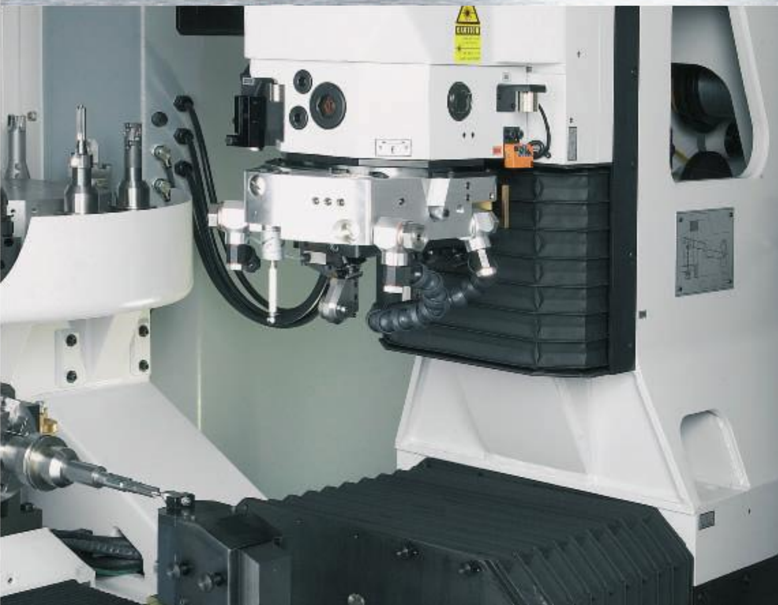
QWD 760 H com magazine para ferramentas de metal: acomoda ferramentas de haste de 85 até 390 mm comprimento, com comprimento de usinagem até 350 mm
